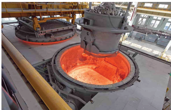
شکل ۴-۱ تولید فولاد با کوره القایی
