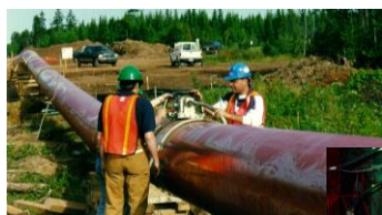
روش بازرسی فراصوتی اتوماتیک
