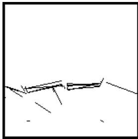
شکل ۴-الف: نقشه زمین به دست آمده در سه حالت، به ترتیب از چپ به راست با استفاده از الگوریتم سوپل در مرحله لبه یابی، استفاده از الگوریتم کنی و بدون انجام پیش پردازش خطوط افقی قبل از بازسازی و استفاده از الگوریتم کنی و انجام پیش پردازش خطوط افقی
