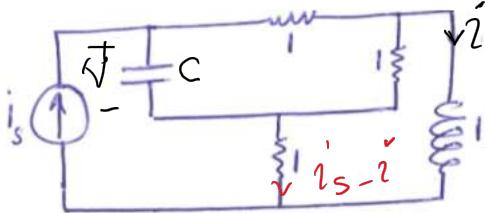
$$\begin{cases} v' - (i_s - i) - v + (i_s - Cv') = 0 \\ (i_s - Cv') + (i_s - Cv' - i) - v = 0 \end{cases} \rightarrow \begin{cases} v' - Cv' = -i + v \\ v_i - i - v = Cv' \end{cases} \rightarrow v' = \frac{1}{\gamma C}(v_i - i - v),$$
