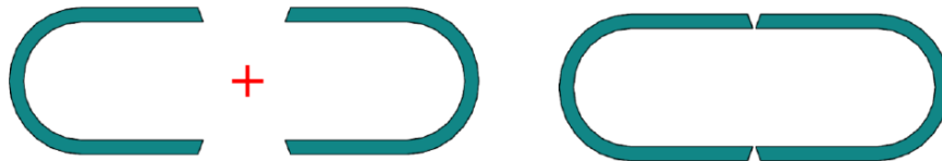
شکل ۱- ترکیب دو میراگر U شکل و ساخت میراگر بیضوی
