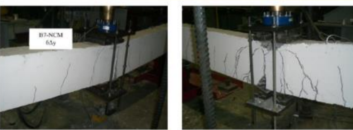
شکل ۸ - سمت چپ: نحوه ترک خوردن تیر های SMA و سمت راست: نحوه ترک خوردن تیر های متداول [۱۰]
