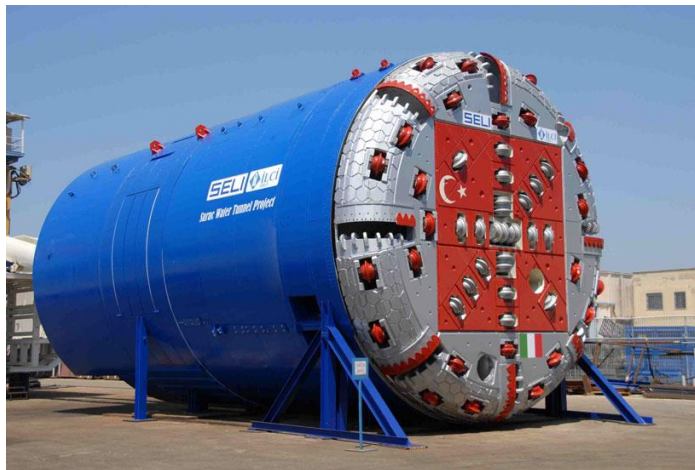
شکل ۱-۱ ماشین حفار تونل TBM
