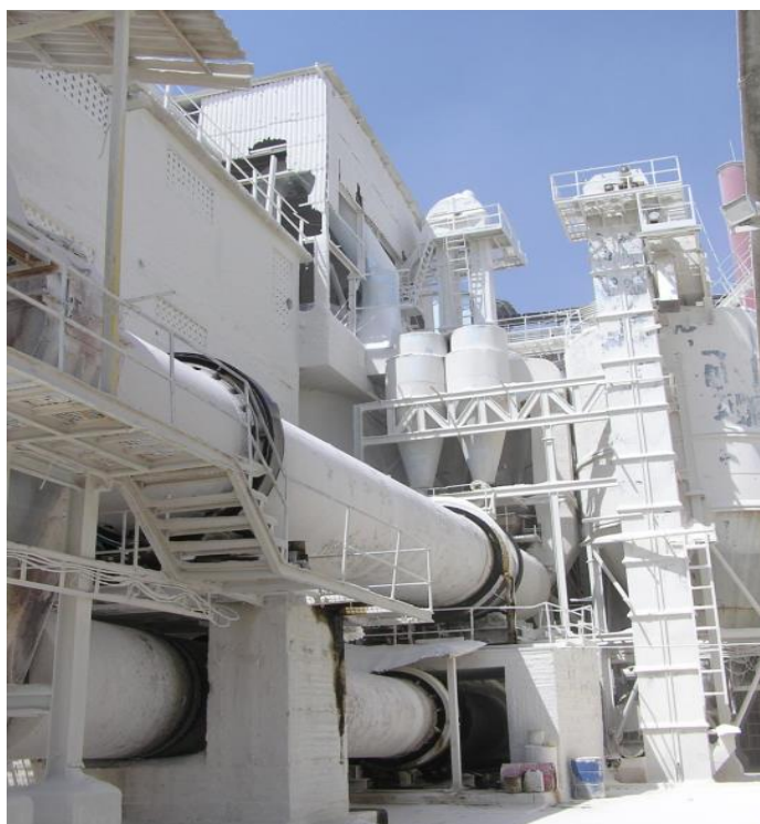
شکل ۲-۱ کوره پیوسته دوار تولید گچ همراه با سرد کن آن
