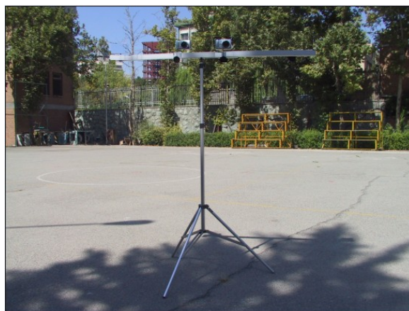
شکل (۸): موقعیت دو دوربین روی میله سیستم تصویربرداری
