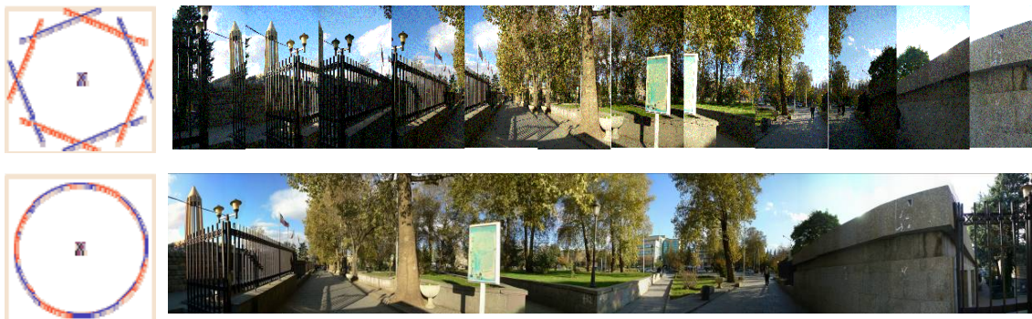
شکل ۵: نمونه ای از عکسهای مجزا (بالا) و نمونه متصل شده آنها به هم جهت تشکیل مدل پانوراما (پایین)
