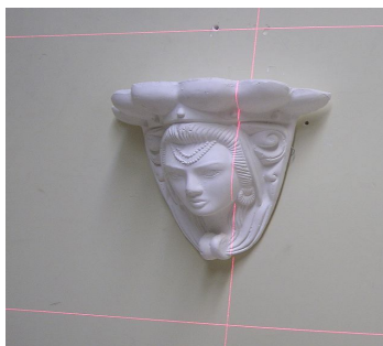
شکل ۴: شمایی از تندیس گچی در حال اسکن
